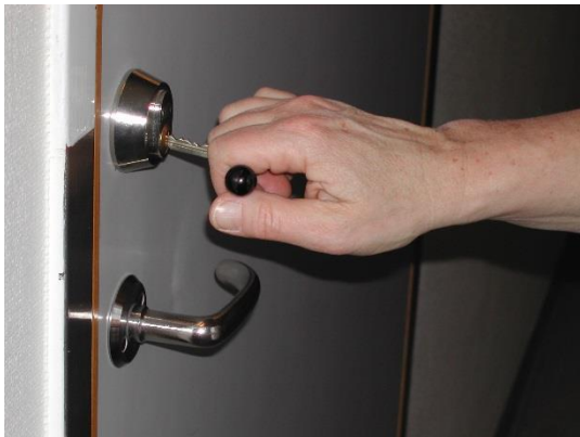
Nyckelgrepp som tillåter grepp med bara fingrarna och ger större hävarm
