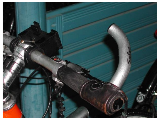
Vinklat handtag på styret minskar belastningen på handleden
